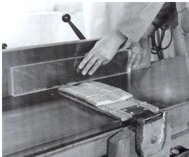
Рисунок 36 - Сглаживание торца на продольно - строгальном станке
