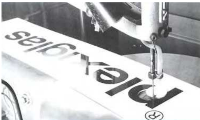
Рисунок 9 - Выпиливание лобзиком логотипа PLEXIGLAS
