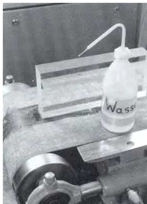
Рисунок 38 - Влажное шлифование на ленточной шлифовальной машине
