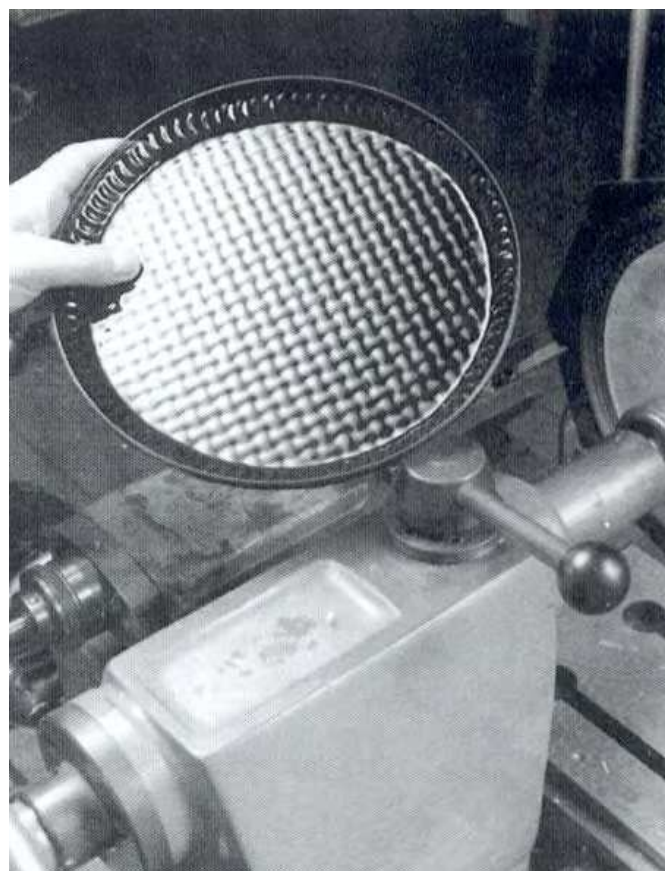
Рисунок 34 - Обрезка края отформованного изделия
