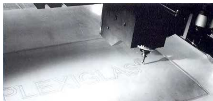
Рисунок 27 - Гравирование при помощи машины с ЧПУ портального типа; одно-кромочная фреза
