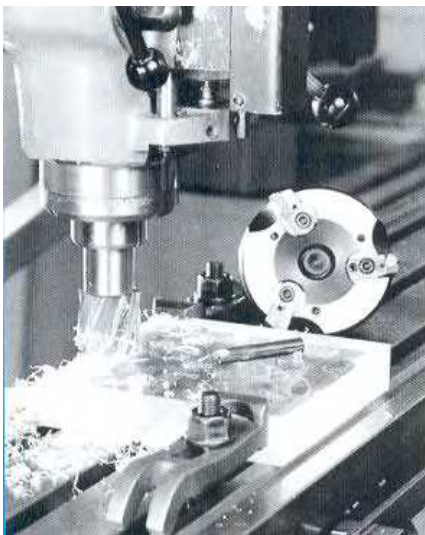
Рисунок 24 - Фрезерование PLEXIGLAS торцевой фрезой; различные другие типы фрез: (а) двух- кромочная фреза; (b) цилиндрическая фреза; (c) алмазная фреза
