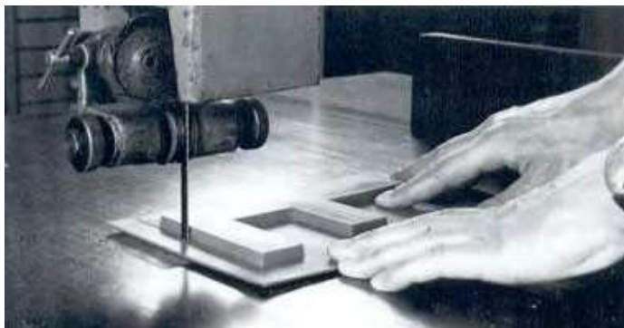
Рисунок 7 – Обрезка края при помощи ленточной пилы
