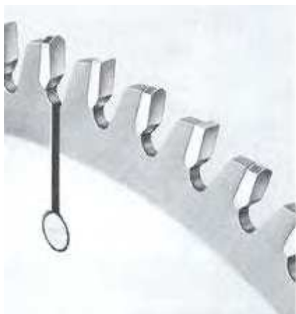
Рисунок – оптимизированный диск для дисковой пилы; форма зуба: плоская трапецевидная, диаметр 300 мм, количество зубьев: 72, шаг зуба ~13 мм
