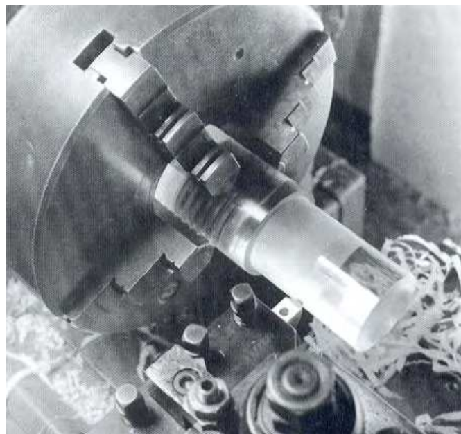
Рисунок 33 - Заготовка, предварительно обработанная инструментом из инструментальной стали, а затем отполированная алмазом
