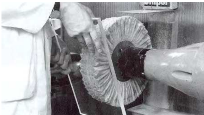
Рисунок 40 - Полировка матерчатым полировальным кругом
